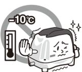
○ Lagern Sie die Pumpe in einem Temperaturbereich von -10 bis 50 Grad Celsius. Temperaturen außerhalb dieses Bereichs können zum natürlichen Verschleiß der Gummiteile (Membran u. Ä.) innerhalb der Pumpe führen.
