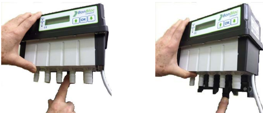
Abbildung 2: Lösen des BonBloc® compact von der Wandhalterung
