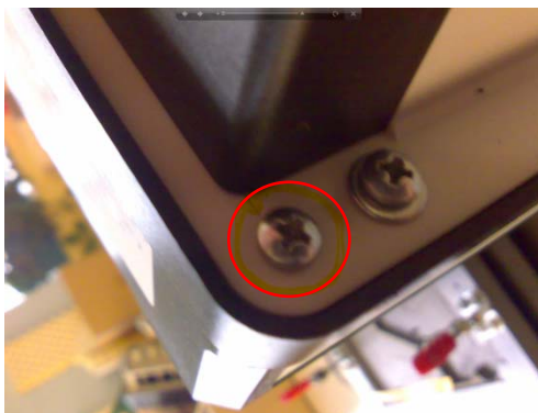
Abbildung 4: Schrauben für die Demontage des oberen Gehäuseteils
