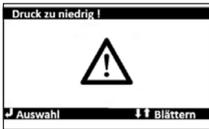
Jede Störung vom Normalbetrieb wird optisch durch eine rote LED und akustisch durch einen Signalton angezeigt. In der Anzeige der Steuerung wird der Fehler durch ein blinkendes Achtungszeichen und als Textmeldung in der schwarzen Überschriftenzeile dargestellt.
