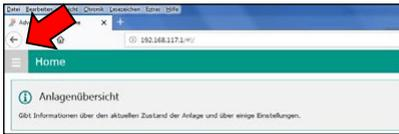
Drücken Sie neben Home auf die Schaltfläche . Es öffnet sich eine Liste mit allen Menüfunktionen. Auch hier erhält man nach Auswahl Zugang zum Menü. Innerhalb der einzelnen Menüs kann durch Drücken der Schaltfläche auf die Liste zurückgekehrt und ein neues Menü ausgewählt werden.
