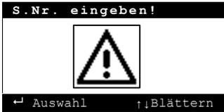
Jede Störung vom Normalbetrieb wird optisch durch eine rote LED und akustisch durch einen Signalton angezeigt. In der Anzeige der Steuerung wird der Fehler durch ein blinkendes Achtungszeichen und als Textmeldung in der schwarzen Überschriftenzeile dargestellt.
