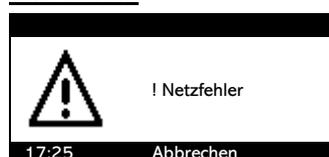
Bei Netzausfall, wird nach etwa 10 sec ein akustischer Alarm ausgelöst und es erscheint das links gezeigte Bild auf dem Display. Die Steuerung kann aus diesem Zustand mit längerem drücken der OK-Taste heruntergefahren werden. Bei Spannungswiederkehr geht die Steuerung automatisch wieder in Betrieb. Netzfehler und Netz OK werden im Logbuch protokolliert.
