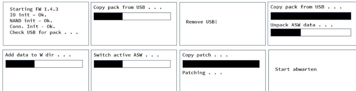
Der Softwareupdate dauert etwa 5 - 6 Minuten. Anschließend geht die Steuerung automatisch in Betrieb. Der vorher eingestellte Anlagentyp, der Parametersatz und manuell geänderte Werte bleiben unverändert erhalten.
