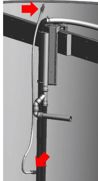
Wiederholen Sie den Vorgang mit den Drucklufthebern für den Klarwasserabzug und die Schlammrückführung am Hebersatz des Basispaketes, der anschließend in die Belegung gehängt wird.
